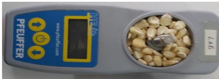
Fig. 9. Pfeuffer HE Lite moisture analyser
